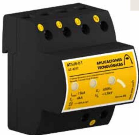
Protección eficaz mediante varistores de óxido metálico y descargadores de gas contra sobretensiones transitorias, para líneas de suministro eléctrico trifásico con neutro **tipo TT**. Protección **media** según la protección en cascada recomendada en el Reglamento de Baja Tensión (REBT ITC23). Especialmente preparado para instalarse en viviendas según la ITC-25 del REBT.
