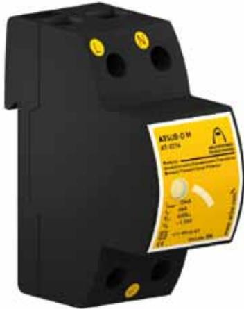
Protección eficaz mediante varistores de óxido metálico y descargadores de gas contra sobretensiones transitorias, para líneas de suministro eléctrico monofásico con neutro **tipo TT**. Protección **media** según la protección en cascada recomendada en el Reglamento de Baja Tensión (REBT ITC23). Especialmente preparado para instalarse en viviendas según la ITC-25 del REBT.
