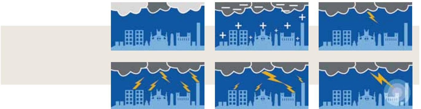
En condiciones normales, existe en la atmósfera un equilibrio entre las cargas positivas y negativas, en el que la tierra está cargada más negativamente que el aire y los elementos situados sobre el suelo.
