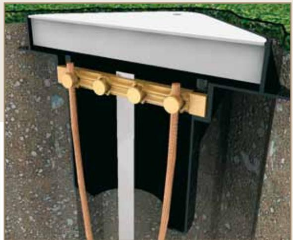
Para obtener una toma de tierra eficaz es fundamental conseguir una resistencia de tierra baja, usando conductores con una sección adecuada para transportar la corriente esperada. Además deben poseer una alta resistencia a la corrosión.
